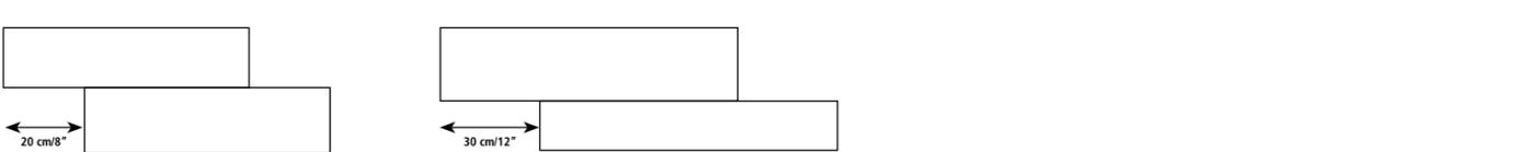
et un joint de **2 mm** minimum en cas de **format unique** et de **2 à 3 mm pour le multi-formats**.
